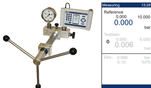
Ejemplo: CPH6000 con sensor de presión de referencia montado firmemente, bomba de husillo manual y elemento de prueba específico del cliente
