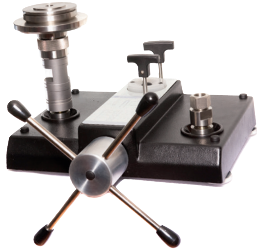
Balance manométrique industrielle en version compacte, type CPB3800
