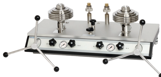
Balance manométrique pour pression différentielle, type CPB5600DP
