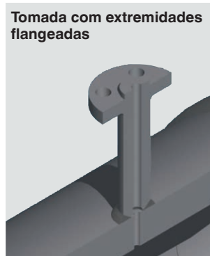
Tomada de pressão por câmara anular fabricado de tubo
