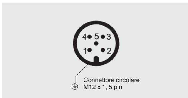
Collegare la schermatura del cavo all'alloggiamento del trasduttore di forza. In caso di cavi accessori, la schermatura del cavo deve essere connessa al dado zigrinato e pertanto connessa all'alloggiamento del trasduttore di forza. Se estesa, devono essere utilizzati solo cavi schermati e a bassa capacità. Le lunghezze massime e minime consentite del cavo sono specificate in ISO 11898-2.
