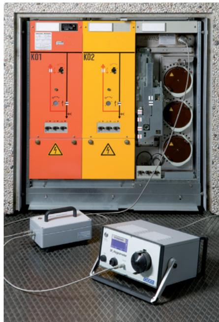
由 GA05 型压力控制装置和 GA40 型分析仪组成的测量组件
