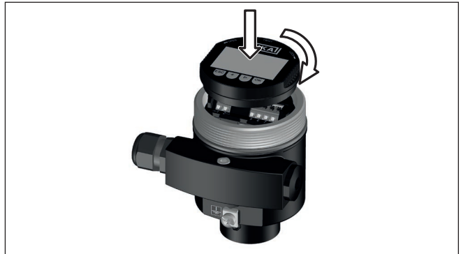
Figura 1: Inserimento del tastierino di taratura con display nel vano dell'elettronica in caso di custodia ad una camera
